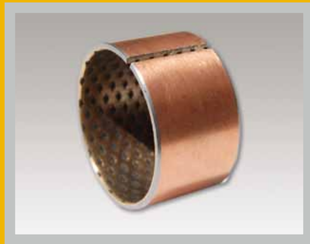
GEROLLTES VERBUNDGLEITLAGER, STAHL/BRONZE, GEFÜLLTE SCHMIERMITTELDEPOTS, WARTUNGSFREI
