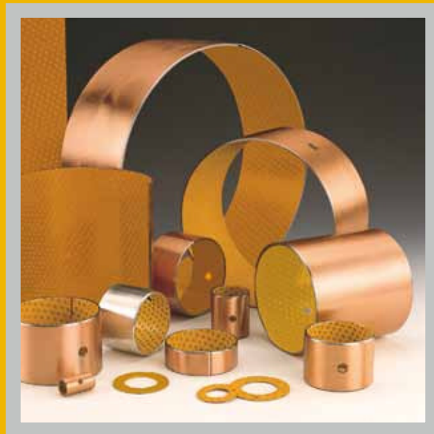
GEROLLTES VERBUNDGLEITLAGER, STAHL / ACETALHARZ (POM), SCHMIERTASCHEN, WARTUNGSARM
